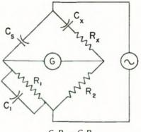
$C_{\mathbf{x}}R_{\mathbf{z}} = C_{\mathbf{z}}R_{\mathbf{z}}$  $C_{\mathbf{x}}R_{\mathbf{z}} = C_{\mathbf{z}}R_{\mathbf{z}}$
