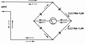
Fig. 912. Full-wave rectifier.
