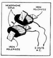
FIG. 15-Demagnetizing phone poles.
