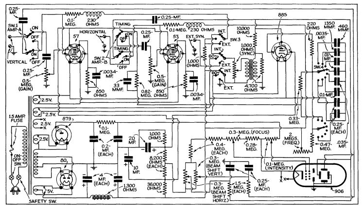
THE CATHODE-RAY OSCILLOSCOPE
