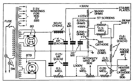
Fig. 16 Voltage Divider Circuit.
