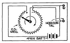
Fig. 27. Mechanical Sweep Circuit
