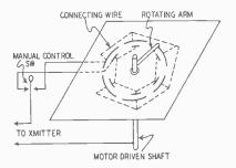
Fig. 202-Motor-driven coder.
