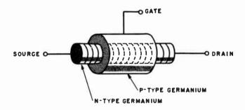
Fig. 1214. Field-effect transistor.
