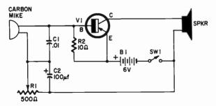
Resistors: R1—500-ohm potentiometer; R2— 10 ohms, 1 watt.
