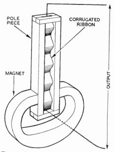
FIG. 6 (b).—PRINCIPLE OF THE RIBBON MICROPHONE
