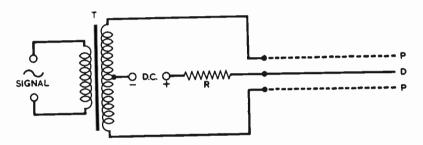
FIG. 14.-ELEMENTS OF A PUSH-PULL ELECTROSTATIC LOUDSPEAKER
