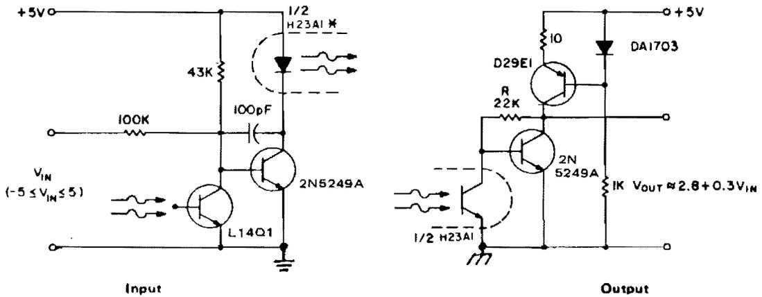
LINEAR OPTICAL COUPLER CIRCUIT
