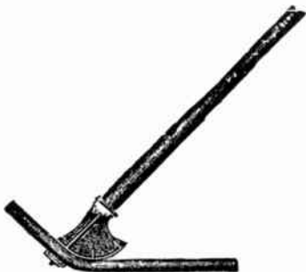
FIG. 7.146 —Rittenhouse conduit bender.
