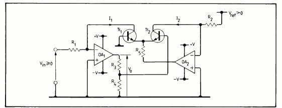
Fig. 3. Simple antilog. circuit.
