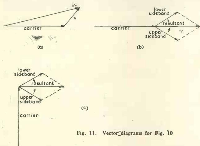
Fig. 11. Vector diagrams for Fig. 10
