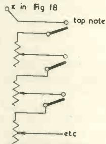
Fig. 19. Pedal tuning stack
