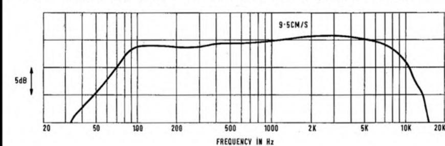
FIG. 3 PHILIPS 4307 RECORD-PLAY RESPONSE (LINE IN, BASF LGS 35, LINE OUT)
