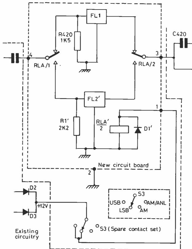
Fig. 2 DUAL FILTER CIRCUIT
