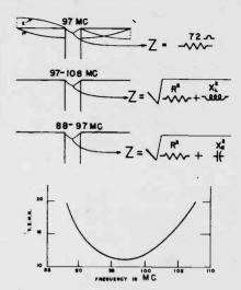
VOLTAGE STANDING WAVE RATIO VS FREQUENCY WESTINGHOUSE STRATOVISION F.M. ANTENNA
