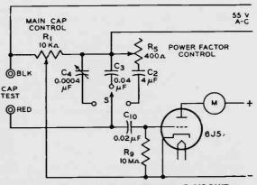
LOW CAPACITANCE BRIDGE CIRCUIT
