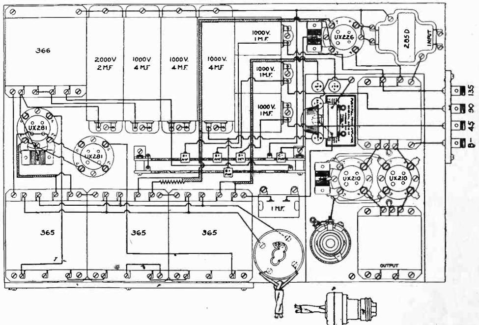
THE PHYSICAL LAYOUT OF THE PUSH-PULL AMPLIFIER AND POWER SUPPLY OF WHICH THE OTHER DIAGRAM SHOWS THE ELECTRICAL ARRANGEMENT. COMPACTNESS IS AN OUTSTANDING FEATURE.
