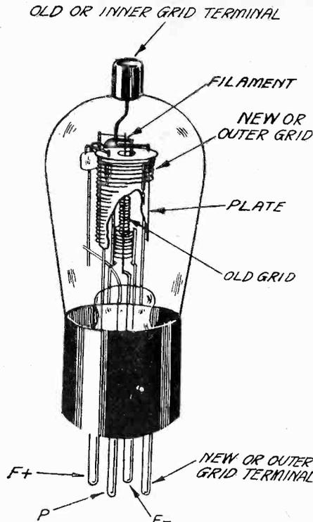
THE ABOVE ILLUSTRATION LUCIDLY SHOWS HOW THE SHIELDED GRID TUBE IS CONSTRUCTED.
