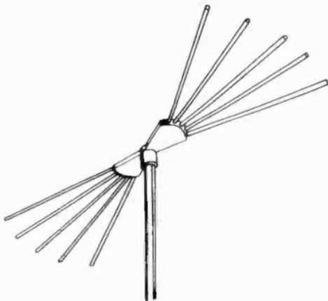
Figure 45. Multi-channel fan antenna.
