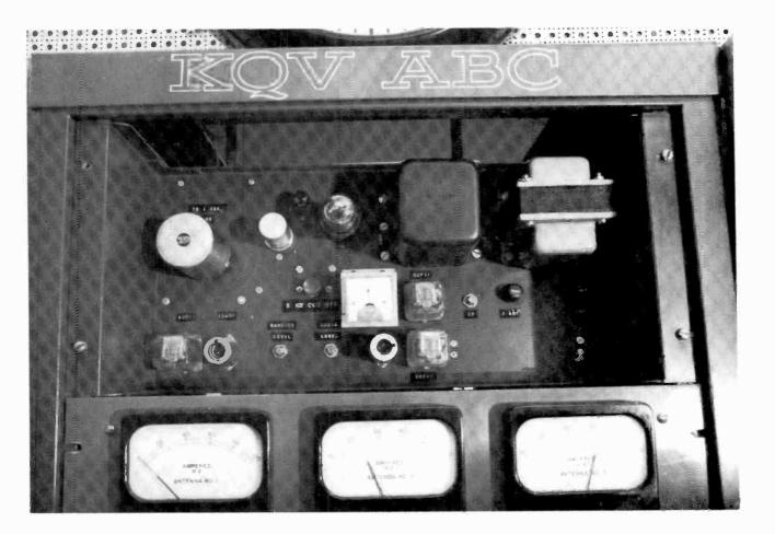
FIG. #6 - FRONT VIEW OF ITA/ABC CARRIER/AUDIO OFF MONITOR
