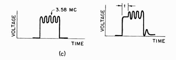
MODULATION WAVEFORMS FOR PULSE RESPONSE TESTS
