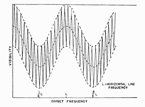
VISIBILITY OF CO-CHANNEL INTERFERENCE AS A FUNCTION OF THE OFFSET FREQUENCY. FIG. 1
