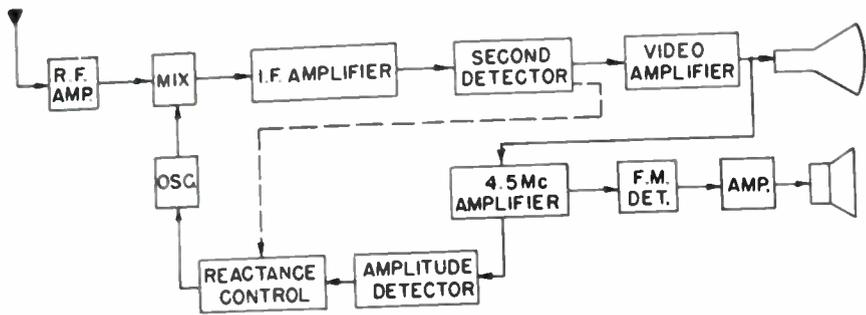
INTERCARRIER SOUND AUTOMATIC FREQUENCY CONTROL SYSTEM
