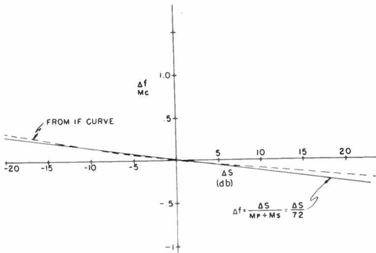
OSCILLATOR FREQUENCY SHIFT DUE TO SOUND TILT.
