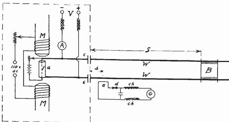
Fig. 2—Experimental circuit.
