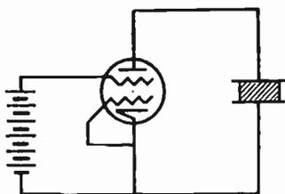
Fig. 8—The p-f crystal controlled dynatron.
