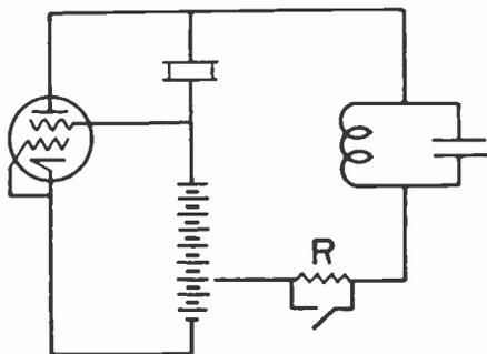
Fig. 3—The *sg-p* crystal controlled dynatron.
