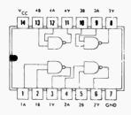
SN7402 QUADRUPLE 2-INPUT POSITIVE NOR GATES
