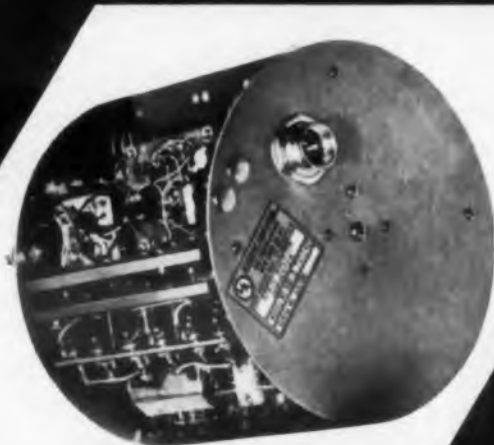
Model SIS 310242 DC-AC Inverter 1300VA, 115/208 Volt 3 \phi
