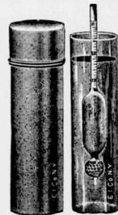
Fig. 1. A Hydrometer
