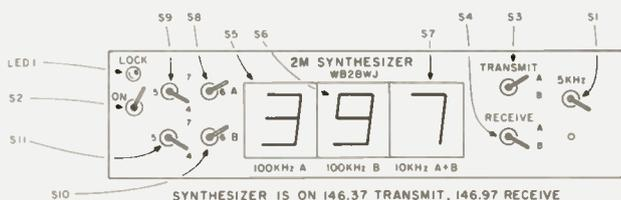
Fig. 5. Switch arrangement.
