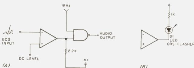
Fig. 6. (a) Qrs-beeper. (b) Qrs-flasher.
