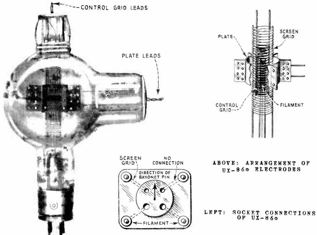
FIG. 4 - THE 100-WATT UX-860 TRANSMITTING SCREEN-GRID TUBE
