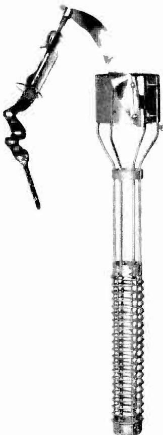
FIG. 14 - GRID CONSTRUCTION
