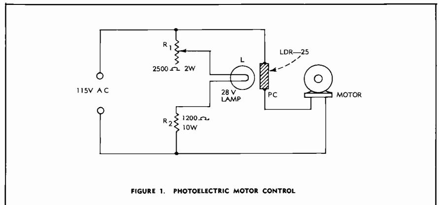
FIGURE 1. PHOTOELECTRIC MOTOR CONTROL
