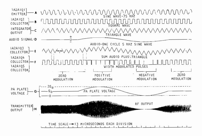
Figure 4-9. PDM Waveform
