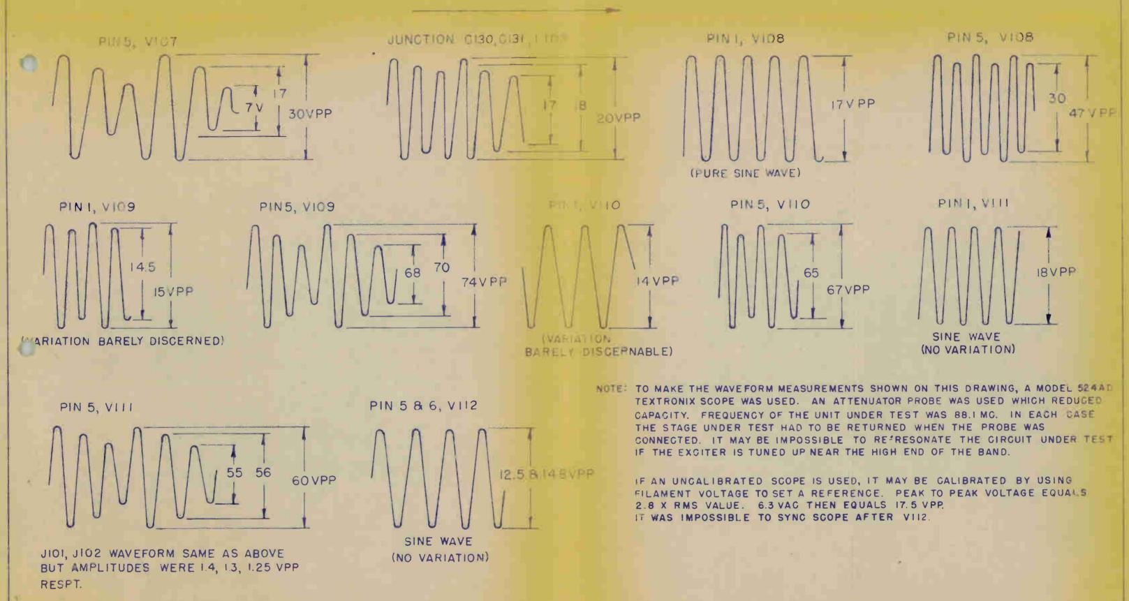
TYPICAL WAVEFORMS OF STAGES VIO7 THROUGH VII2. M6095 EXCITER
