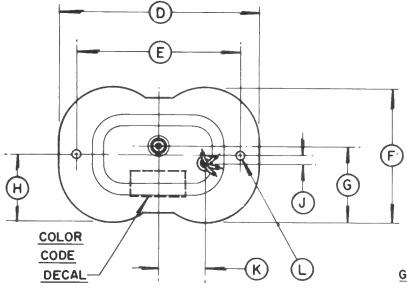
CONNECTIONS GROUND - GREEN HEATER - WHITE HEATER CATHODE - BLACK INJECTION ANODE - YELLOW
