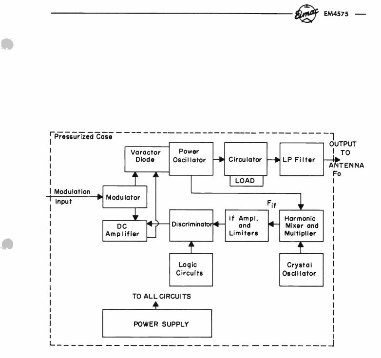
BLOCK DIAGRAM MODEL EM4575 4W S-BAND TELEMETRY TRANSMITTER
