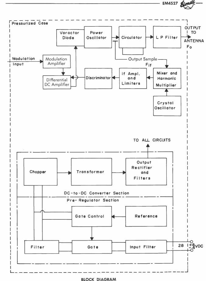
MODEL EM4527 2W S-BAND TELEMETRY TRANSMITTER
