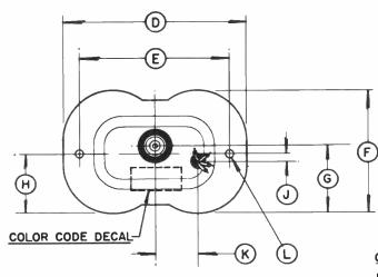
CONNECTIONS GROUND - GREEN HEATER - WHITE HEATER CATHODE - BLACK INJECTION ANODE - YELLOW
