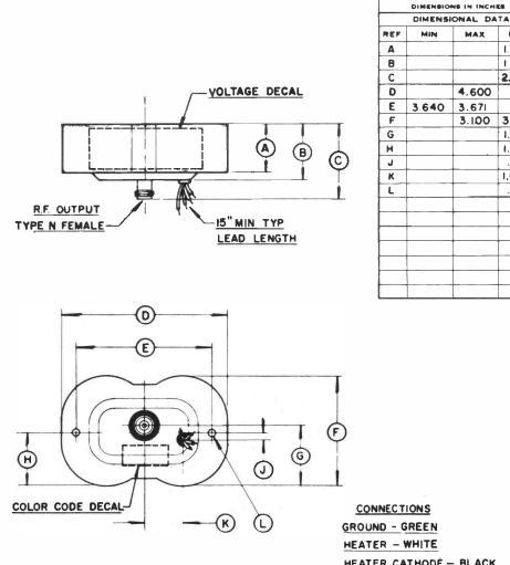
HEATER CATHODE - BLACK INJECTION ANODE - YELLOW
