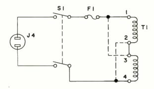
CONNECTIONS FOR 230 VAC SINGLE PHASE OPERATION II5 VAC SHOWN IN DOTTED LINES VALUE OF FI FOR OPERATION ON 230 VAC IS .5 AMPERE.
