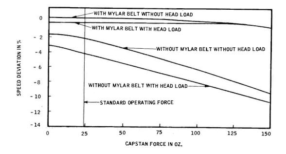
Fig. 7 TURNTABLE SPEED VARIATION VERSUSCAPSTAN FORCE
