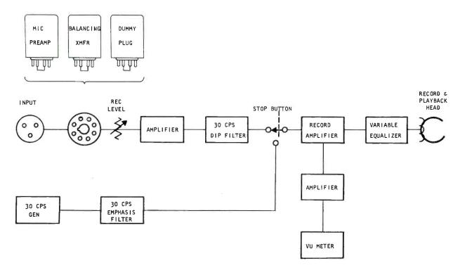
Fig. 8 RECORD CIRCUIT BLOCK DIAGRAM
