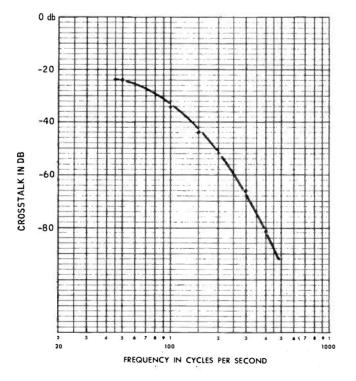
Fig. 2 TRACK-TO-TRACK CROSSTALK VERSUS FREQUENCY
