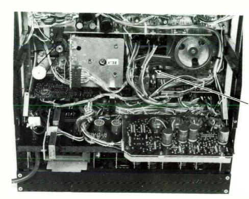
PINCH ROLLER SOLENOIO MOUNTING SCREWS (3)
