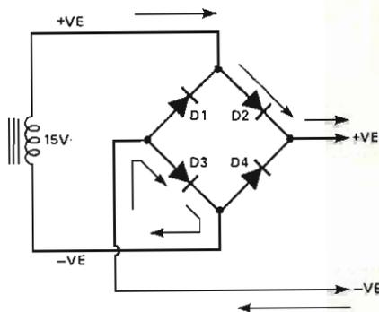
Figure 4. Bridge rectifier
