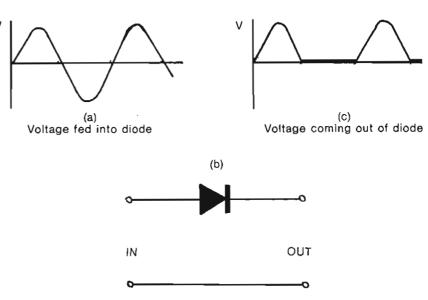
Fig. 3. Half-wave rectifier.
