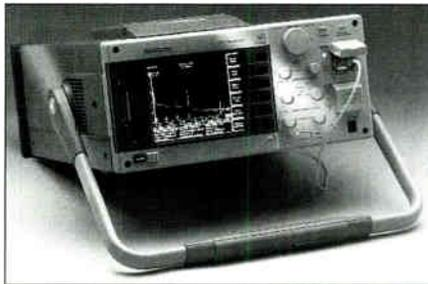
*Tektronix' FiberMaster™ OTDR*
