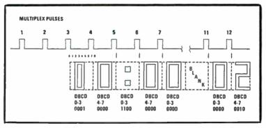
Fig. 9-7. Clock IC outputs.
