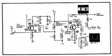
Fig. 4-7. RF AGC circuit.
