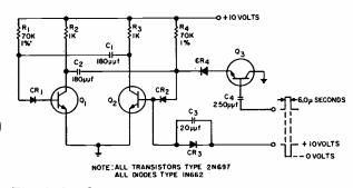
Fig. 1-Synchronized oscillator.
