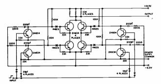
Fig. 1-Redundant msmv circuit.
