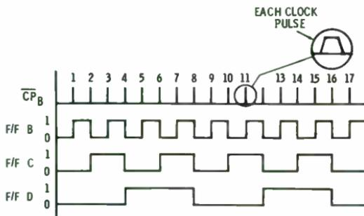
Fig. 6-3. Waveforms for Fig. 6-1.
