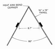
Fig. C-26. PZM wedge or axe (top view).
