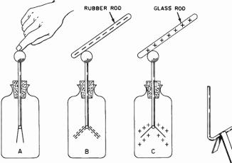
Fig. 3-7. A foil electroscope.
