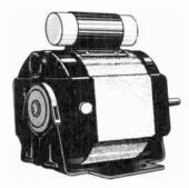
Fig. 13-24. A capacitor-start motor.
