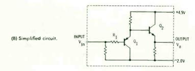
Fig. 6-9. Basic CTL circuits.
