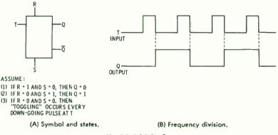
Fig. 5-5. R-S-T flip-flop.
