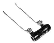
Fig. 3-2. Fixed wirewound resistor.
