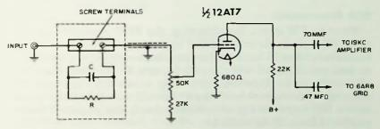
Fig. 5-7. Altec Lansing 359A input circuit.
