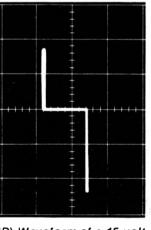
(D) Waveform of a 15-volt zener diode.
