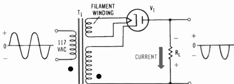
Fig. 4-10. Half-wave vacuum-tube rectifier.
