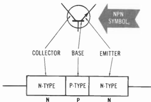
Fig. 3-20. Npn transistor symbol.
