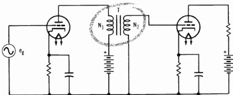
**Fig. 5-20. Transformer coupling.**
