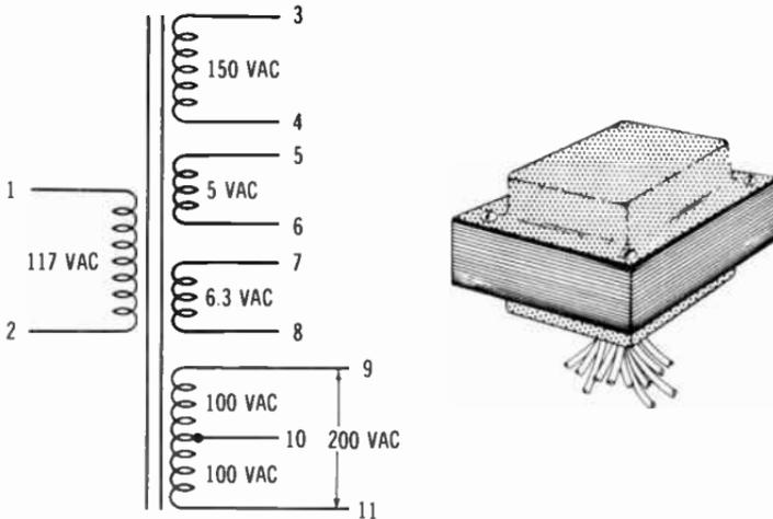
**Fig. 4-6. A power transformer.**
