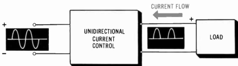
**Fig. 4-2. Rectification principle.**
