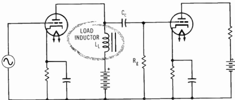
**Fig. 5-19.** Impedance-coupled amplifier.
