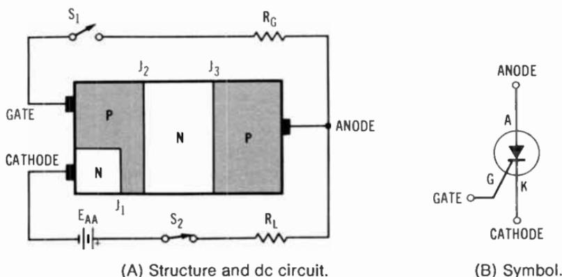
**Fig. 8-14. Silicon controlled rectifier.**
