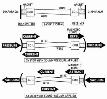
A BASIC SOUND-POWERED TELEPHONE SYSTEM
