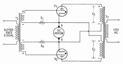
A BIDIRECTIONAL THYRATRON DC SERVO AMPLIFIER
