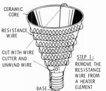
MAKING A SIMPLE RESISTOR
