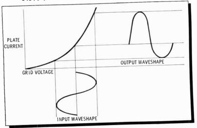
DISTORTION DUE TO NONLINEAR OPERATION
