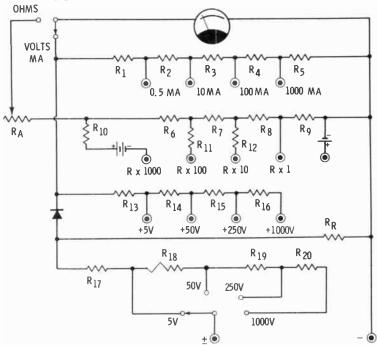
**COMPLETE MULTIMETER CIRCUIT**
