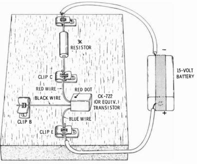
A TRANSISTOR VOLTAGE DIVIDER
