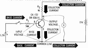
A SIMPLE TRANSISTOR AMPLIFIER CIRCUIT
