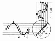
LISSAJOUS FIGURE — WAVEFORMS IN PHASE
