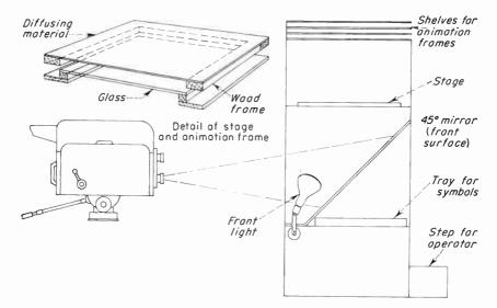
Fig. 13-23. Diagram of Bretzicon.
