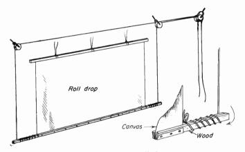
Fig. 16-7. Simple roll drop.
